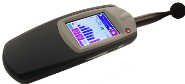
Obr. 2. Bedrock SM50 STIPA meter [7]. Prístroj vyvinutý ako STIPA meter na základné aj vyspelejšie meranie STIPA, obsahuje aj moduly pre ďalšie akustické merania, ako je real-time analyzátor spektra a merač akustického tlaku.
